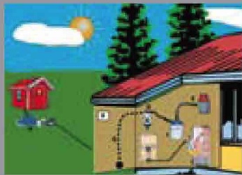
ΚΙΤ 1: Σύστημα μεταφοράς pellets από εποχιακή δεξαμενή στο σιλό του λεβητοστασίου
