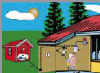
ΚΙΤ 3: Σύστημα μεταφοράς pellets από εποχιακή δεξαμενή απευθείας στον καυστήρα.
